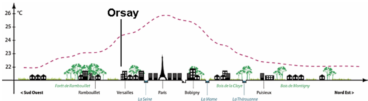
Figure 69 : Coupe schématique de visualisation des températures en 2008 pour une nuit de canicule (type été 2003) (source : Groupe Descartes)
