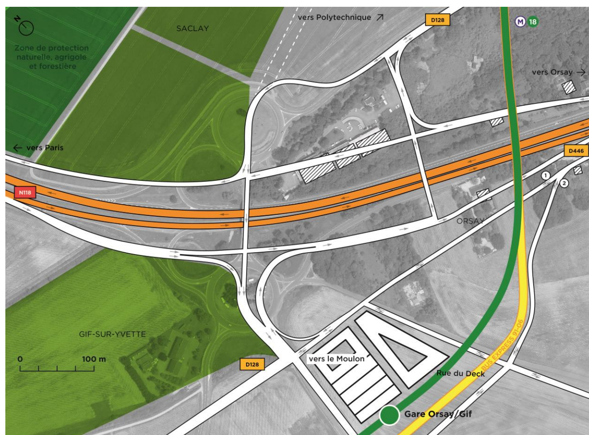
Figure 7. Configuration de l'échangeur de Corbeville envisagée dans le cadre du scénario n°6. (NB : deux solutions alternatives – ① ou ② – sont également montrées pour le rétablissement de la route de Versailles)
