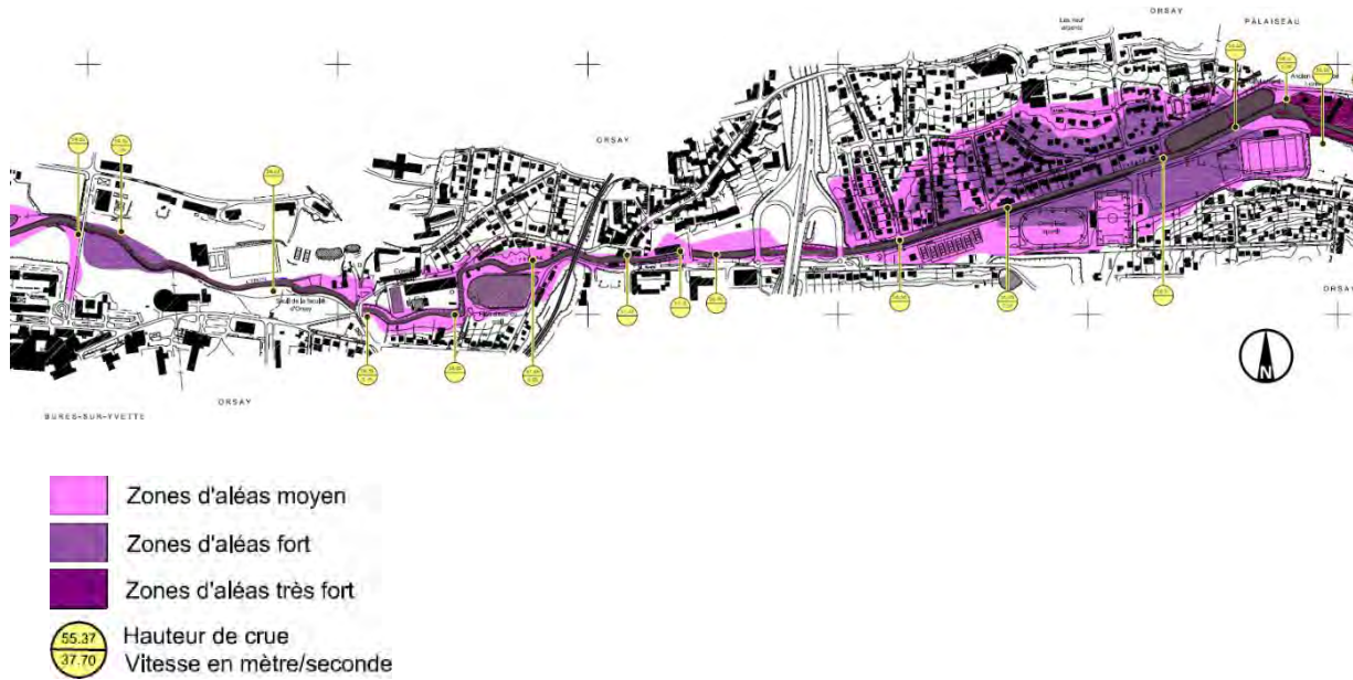
Carte des aléas d'inondation (source : PPRI de la vallée de l'Yvette – septembre 2006)
